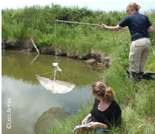
Mise en place de la balance. L'appât se trouve dans le sac percé accroché au milieu.
